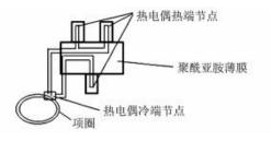
图 1 睡眠呼吸监测传感器的示意图
