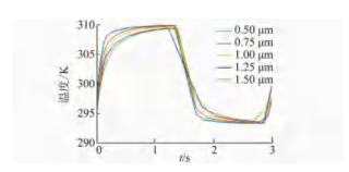
图 10 热电偶不同厚度下的温度变化
