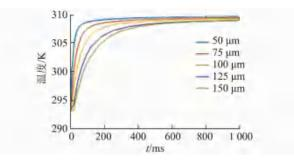
图 7 不同薄膜厚度下的温度变化
