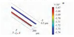
图 8 单热电偶的热电耦合仿真结果
