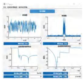
图 8 IIR 数字低通滤波器
