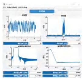
图 9 FIR 数字带通滤波器
