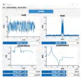
图 10 IIR 数字带通滤波器
