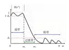
图 1 数字低通滤波器的幅频响应
