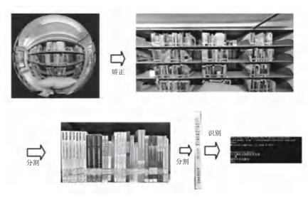
图 3 实验系统图像处理流程
