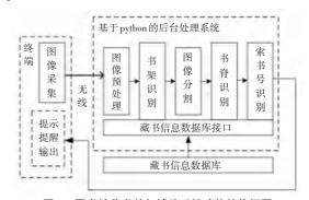
图 1 图书馆藏书整架辅助系统功能结构框图
