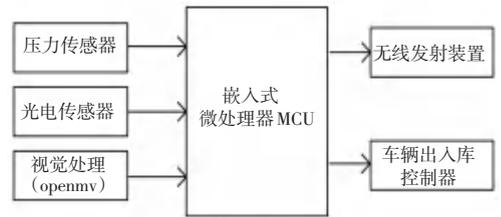
图2 安全检测装置结构图
