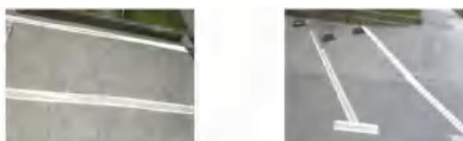
图3 使用PPHT与直线聚类在ROI检测标记线
